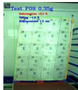
Deformación final P9 a 0,35g
