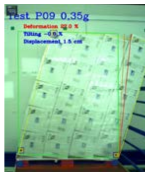
Deformación dinámica P9 a 0,35g
